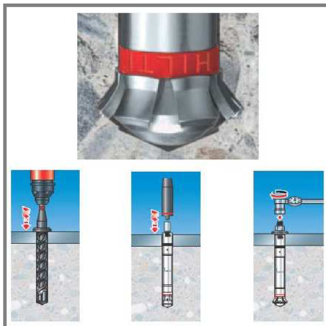
Obr. 7.3 Mechanické kotvení – postup [15]
