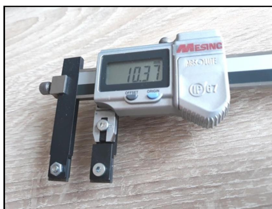
Obr. 4-1: Měřidlo osazené doteky z vyvinutého kompozitu [35]
