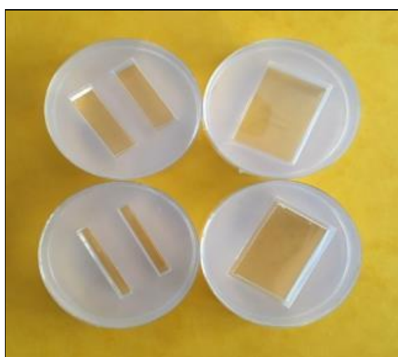
Obr. 3-3: Silikonové formy pro odlévání vzorků [35]
