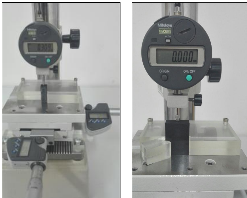
Obr. 3-9: Detail měřicího systému s křížovým stolem [35]
