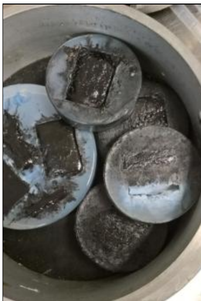
Obr. 3-7: Naplněné silikonové formy [35]
