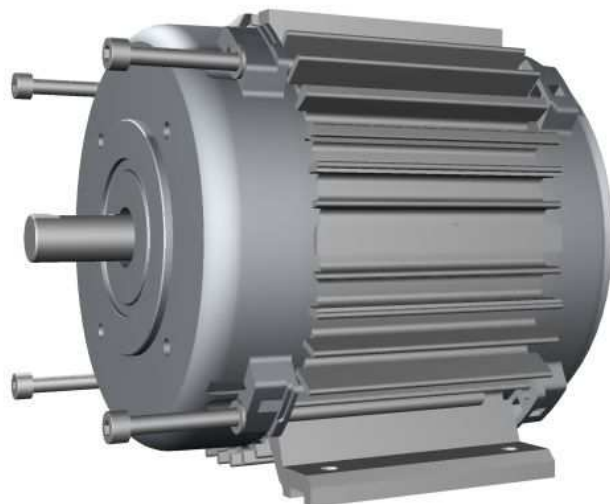
Obrázek 4.21 – Sesazení ložiskových štítů a umístění šroubů
