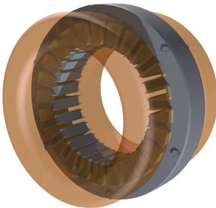
Obrázek 4.19 – Zobrazování vinutí statoru
