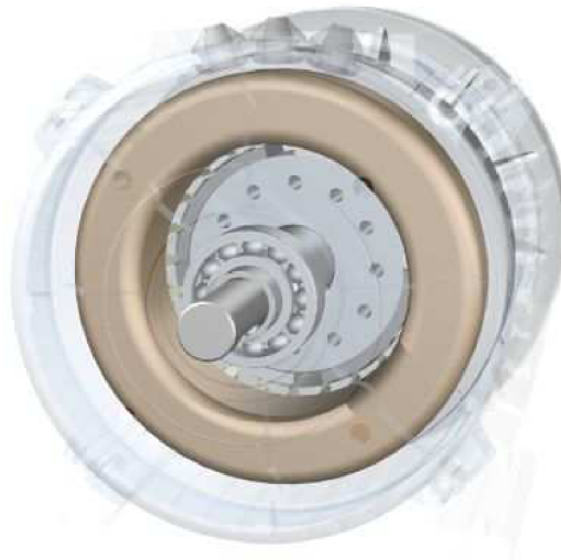
Obrázek 4.23 – Zprůhledněný plášť motoru při závěrečném otáčení rotoru
