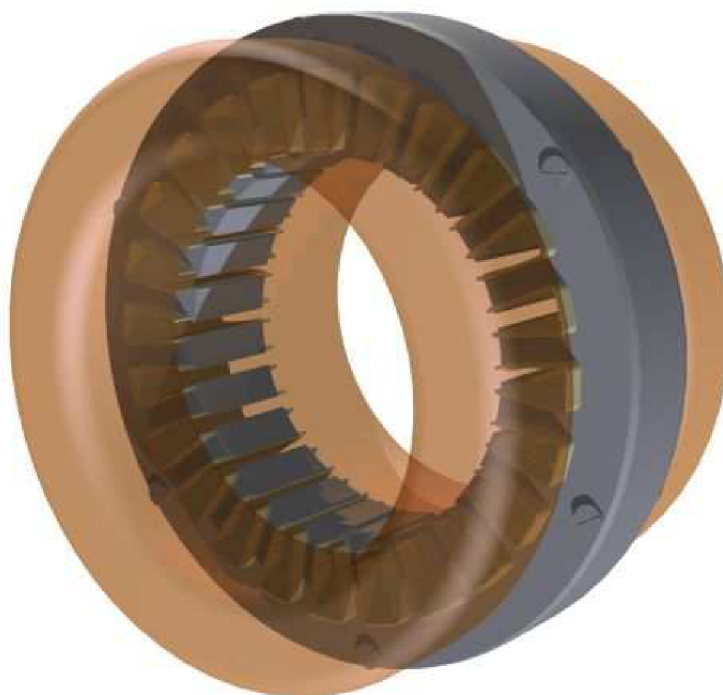
Obrázek 4.19 – Zobrazování vinutí statoru
