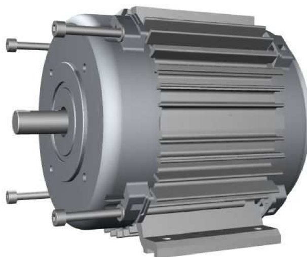
Obrázek 4.21 – Sesazení ložiskových štítů a umístění šroubů
