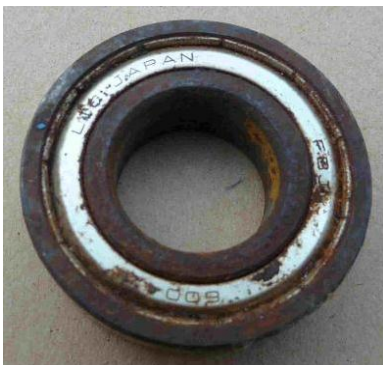
Obr. 20 Ložisko opotřebené korozí
