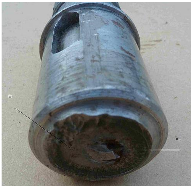
Obr. 23 Zlomená hřídel motoru (lom únavový)
