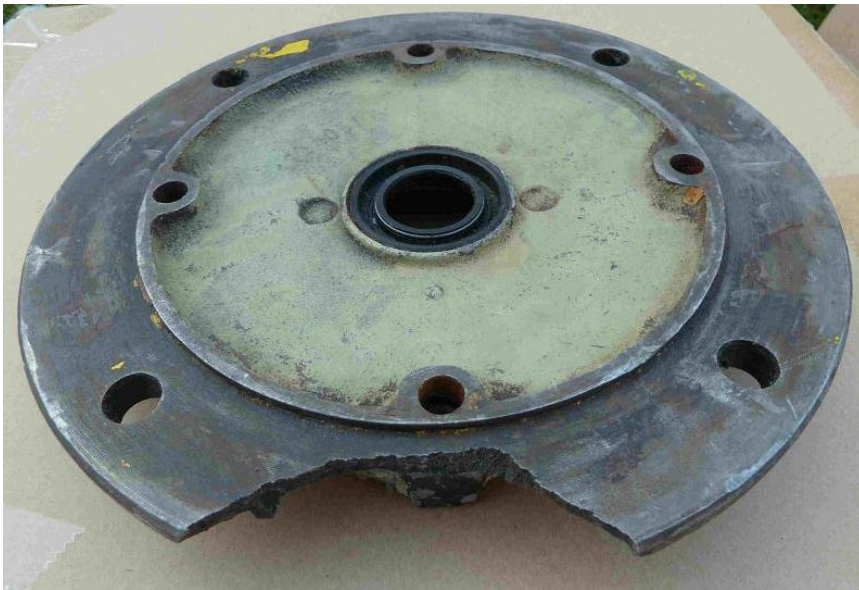
Obr. 22 Příruba motoru poškozená lomem statickým
