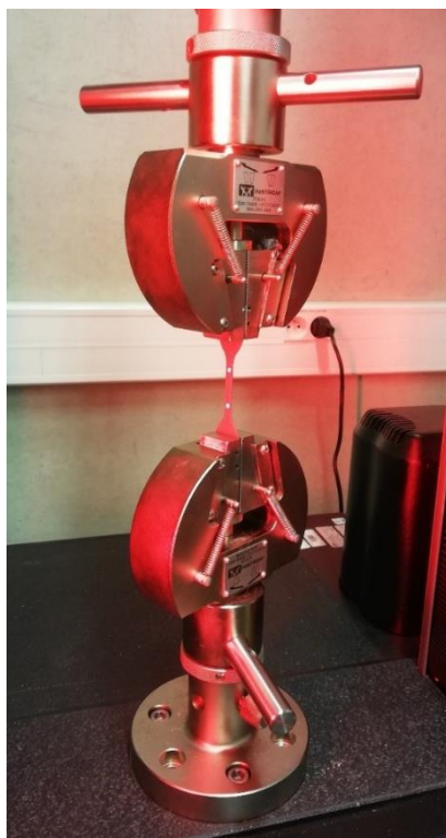
Obr. 8 Upnutí vzorku do klínových čelistí Instronu
