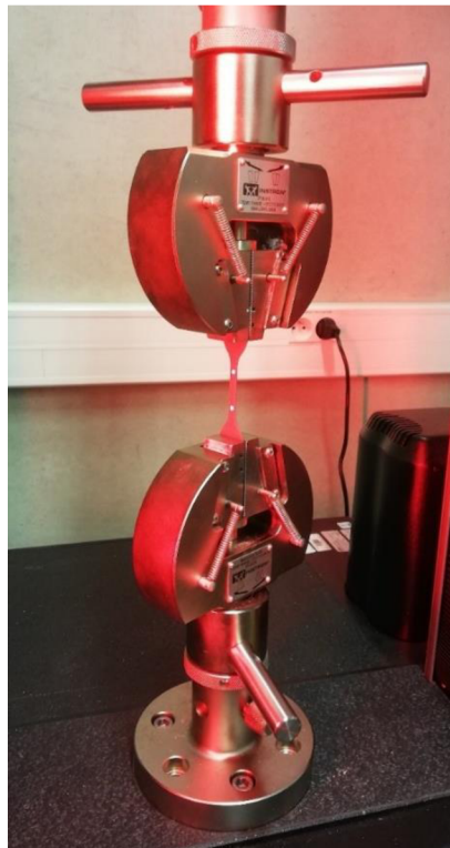
Obr. 8 Upnutí vzorku do klínových čelistí Instronu
