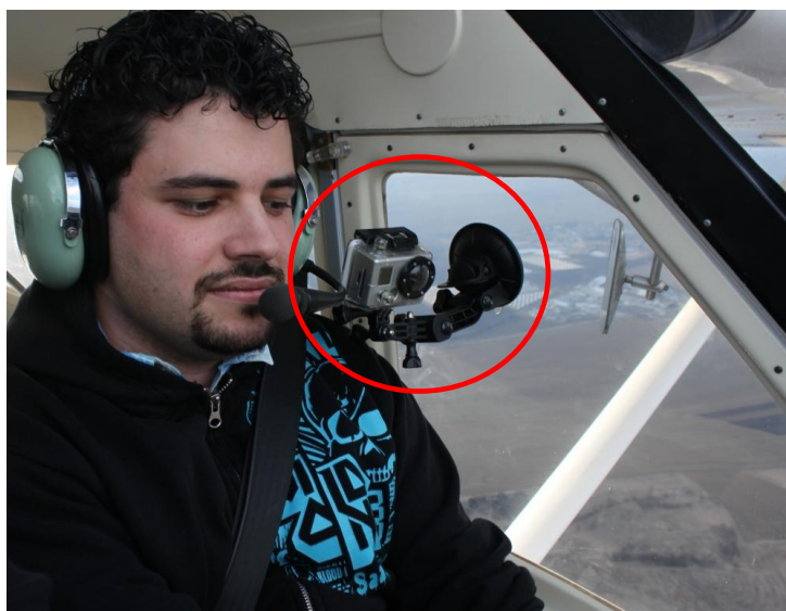
Obrázok 5.2: Umiestnenie kamery počas experimentálneho letu
