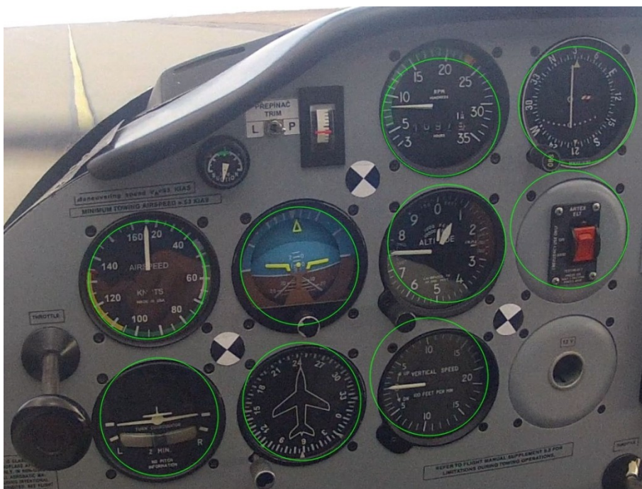
Obrázok 4.2: Automatická detekcia polohy letových prístrojov
