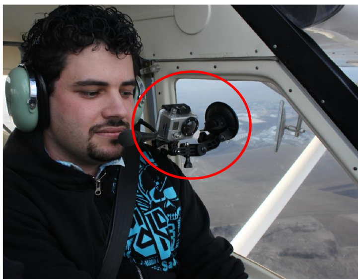
Obrázok 5.2: Umiestnenie kamery počas experimentálneho letu
