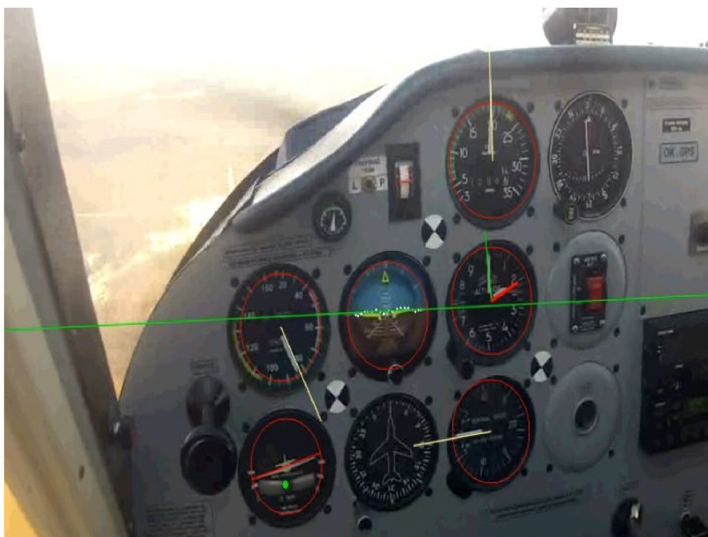
Obrázok 5.5: Výstup aplikácie pri štandardných podmienkach viditeľnosti analyzovaných prístrojov.
