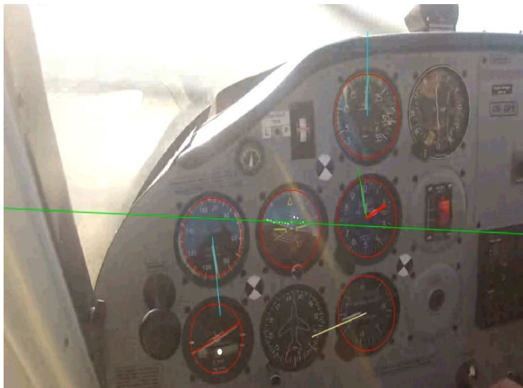
Obrázok 5.8: Nevhodné osvetlenie scény spôsobuje nedostatočný kontrast farieb na priečnom relatívnom sklonomere a umelom horizonte v dôsledku čoho analýza trpí nepresnosťou.
