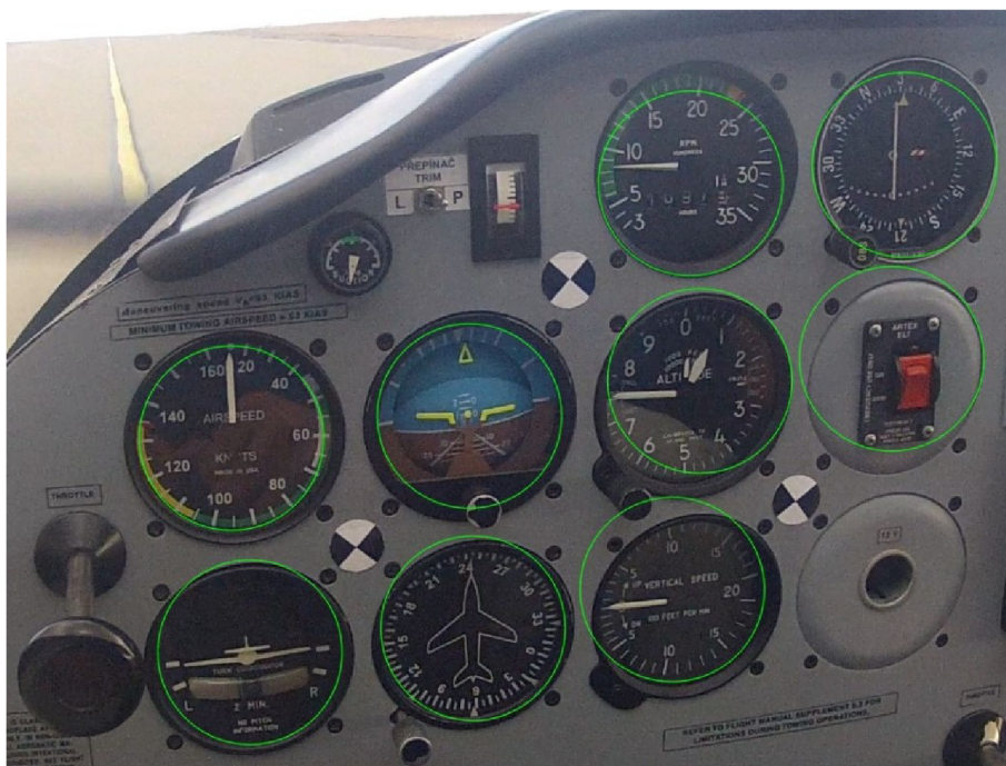
Obrázok 4.2: Automatická detekcia polohy letových prístrojov
