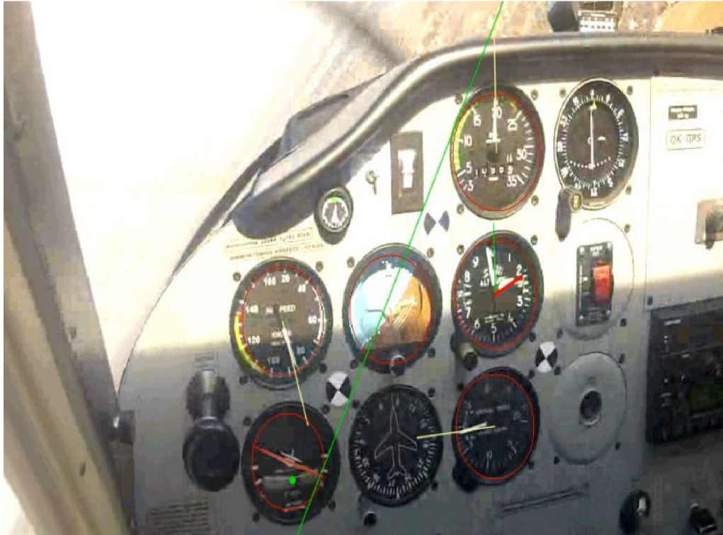
Obrázok 5.9: Chyba detekcie hodnoty indikovanej prístrojom umelý horizont spôsobená nevhodným osvetlením skresľujúcim analyzovanú farbu prístroja.
