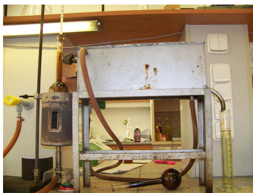
Obr. 16. Soustava pro destilační zkoušku. Zdroj: autor
