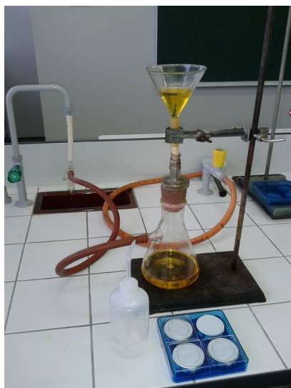
Obr. 22. Průběh filtrace vzorku pro stanovení obsahu celkových nečistot. Zdroj: autor
