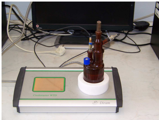
Obr. 15. Automatizovaný coulometrický titrační přístroj pro zjištění obsahu vody. Zdroj: autor
