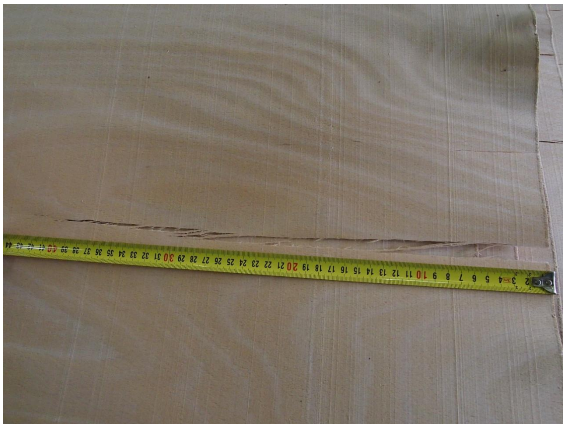
Obr. 21.; Trhlina o délce 40 cm
