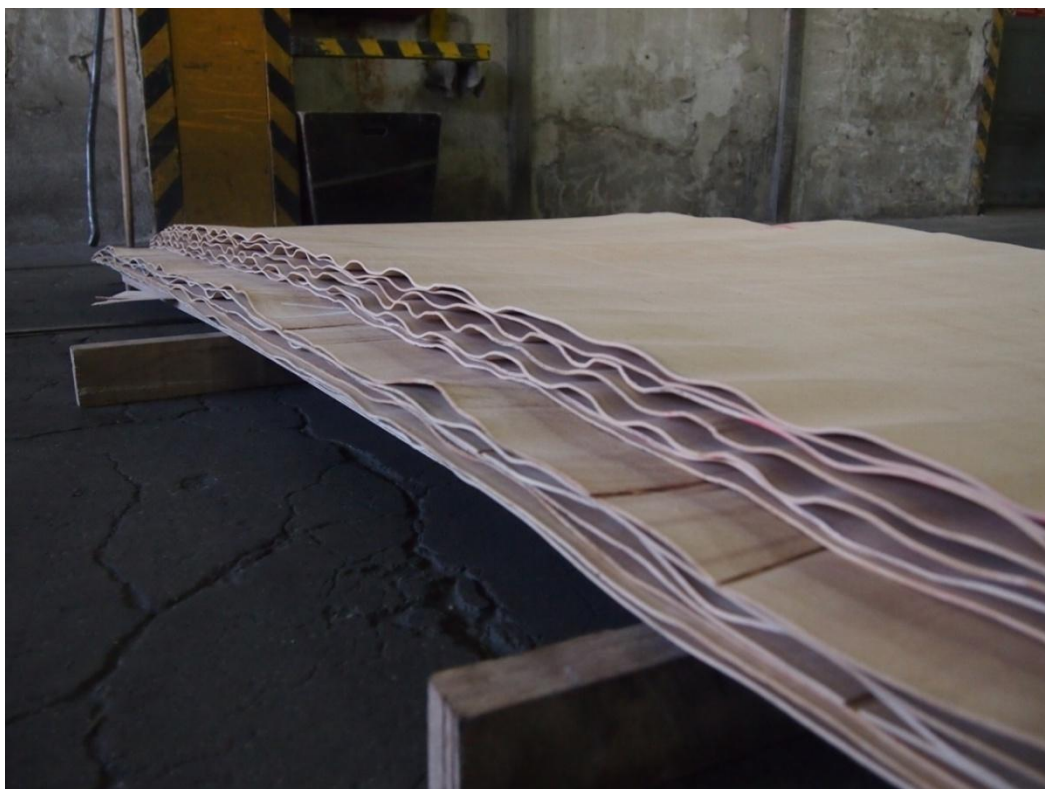
Obr. 13.; Spodní vrstva dýhové listy bez přeložení, vrchní vrstvy dýhové listy s přeložením
