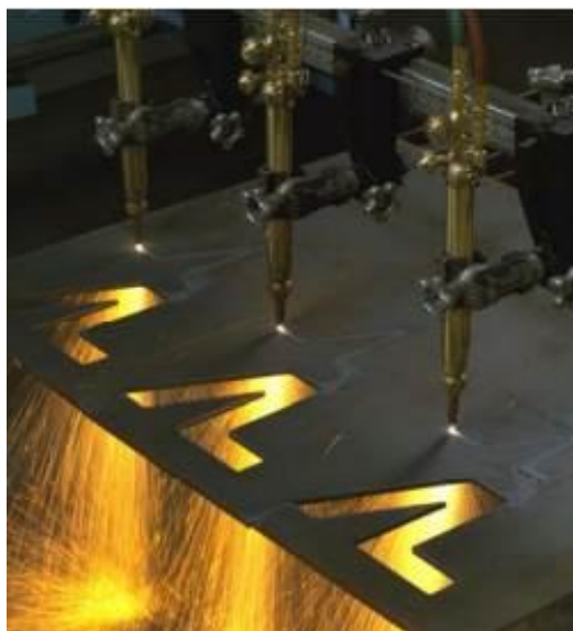
Obr. 3 Strojní řezání kyslíkem [10]
