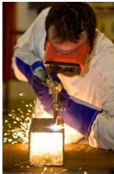
Obr. 4 Ruční řezání kyslíkem [11]
