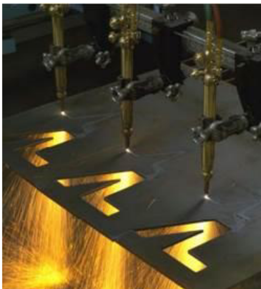
Obr. 3 Strojní řezání kyslíkem [10]
