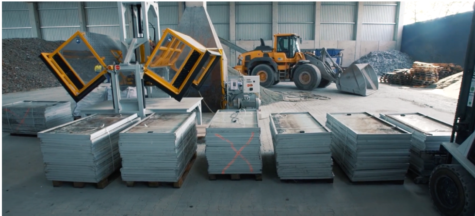
Obrázek č. 19: Technologie uskladnění solárních panelů [65]
