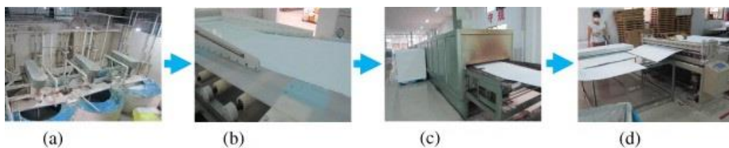
Obrázek 15: Výrobní proces vrstev jádra ze skelného vlákna [6]
