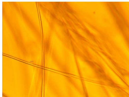
Obrázek 37: Akrylové vlákno při 40násobném zvětšení
