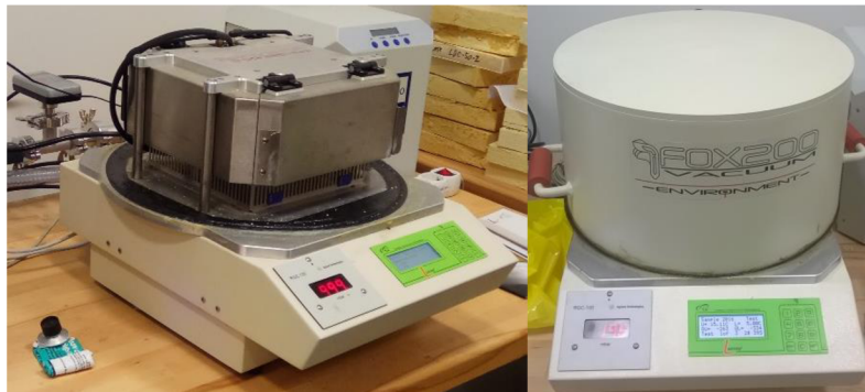
Obrázek 32: Měřicí přístroj FOX200 vacuum
