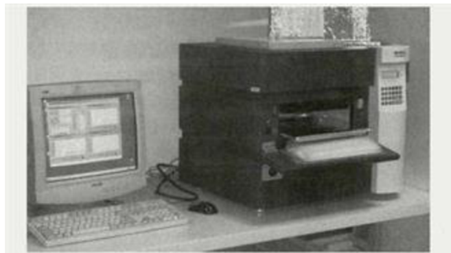
Obrázek 21: Laboratorní měření tepelné vodivosti [17]
