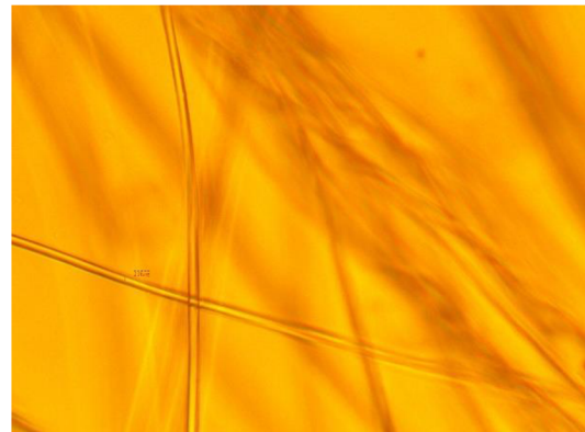
Obrázek 37: Akrylové vlákno při 40násobném zvětšení
