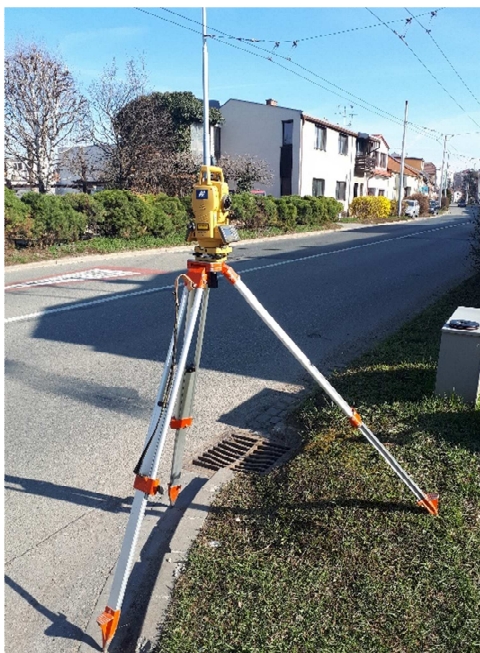
Obr. 9 Totální stanice Topcon na stanovisku č. 524 při měření podrobných bodů; zdroj [foto autora práce]
