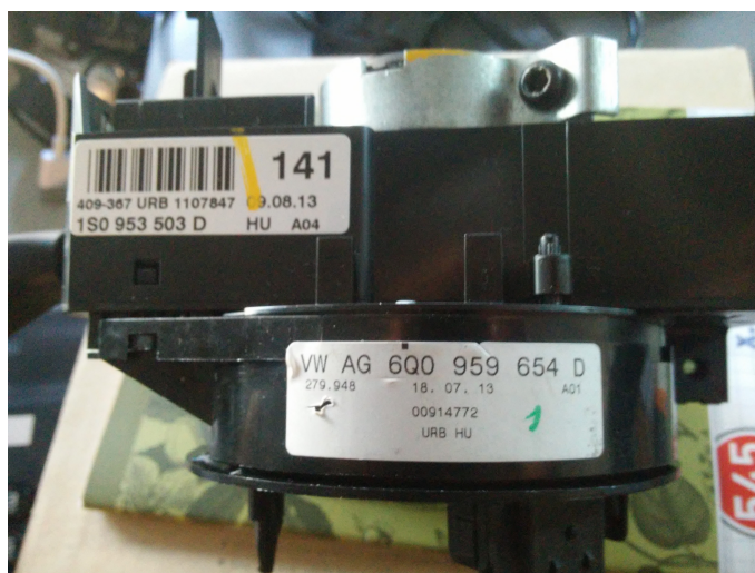
Obrázek 3.5: Podvolantová jednotka používaná ve vozech Škoda
