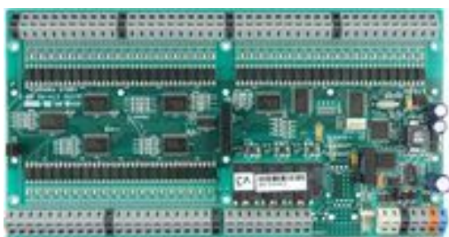
Obrázek 5-20 modul vstupů a výstupů Quido [32]
