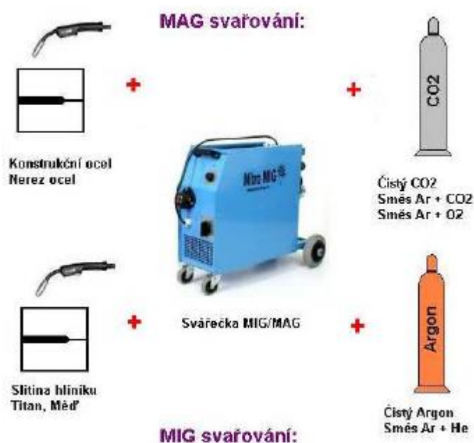
Obr. 10: Svařovací zařízení pro svařování MIG/MAG
