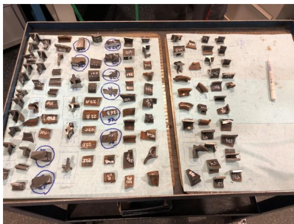
Obr. 12: Příprava jednotlivých vzorků pro broušení, leštění a následné leptání
