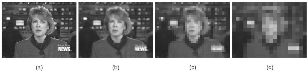
Obrázek 1.3: (a) n = 1 , původní obraz. (b) n = 4 . (c) n = 8 . (d) n = 16 . Ukázka hierarchie obrázků s podvzorkováním. Každá buňka se skládá z n * n pixelů s hodnotou průměru z těchto pixelů
