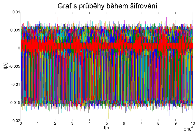
Obr. 3.13: Graf s průběhy během šifrování proudové sondy
