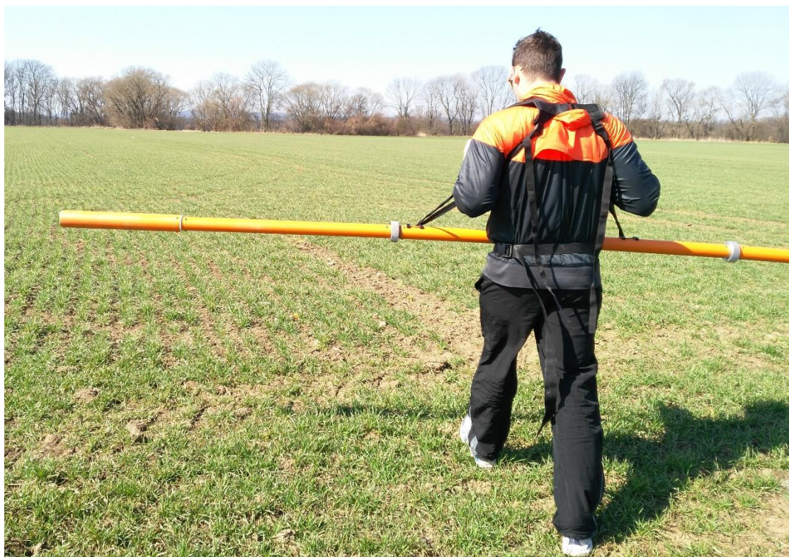
Obrázek 7 - Přístroj CMD-4 a manipulace během měření
