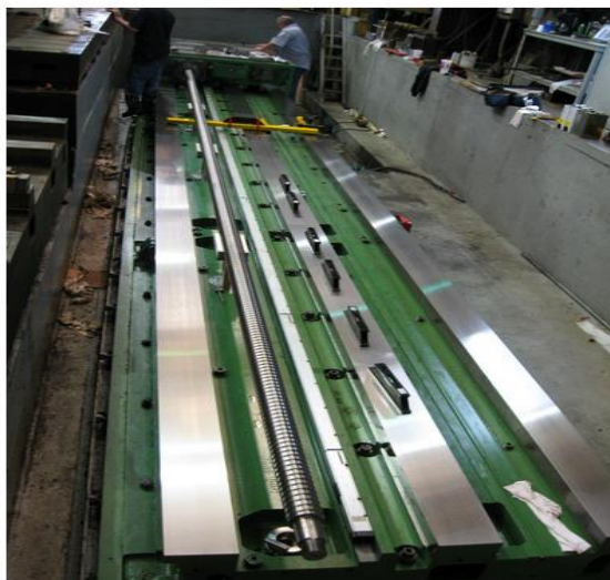
Obr. 2.7: Dlouhý kuličkový šroub s podpěrami od firmy Barnes Industries [22]
