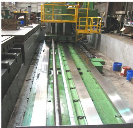
Obr. 2.7: Dlouhý kuličkový šroub s podpěrami od firmy Barnes Industries [22]
