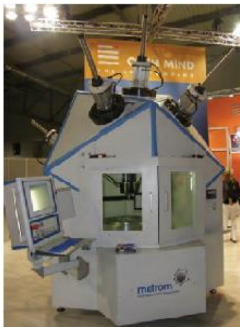
Obr. 3.1: Obráběcí stroj Metrom P1000 s paralelní kinematikou [25]
