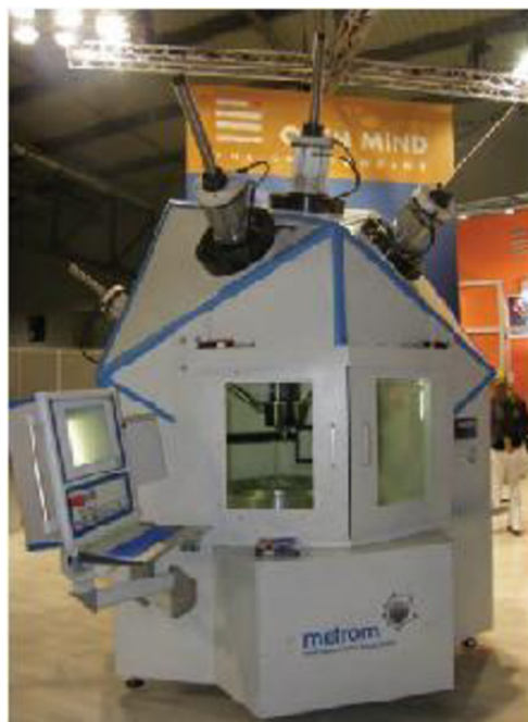
Obr. 3.1: Obráběcí stroj Metrom P1000 s paralelní kinematikou [25]
