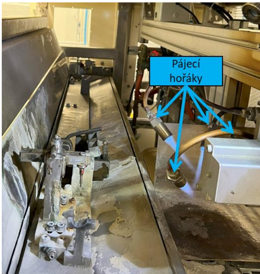
Obr. 3.3 Pájecí hořáky uvnitř pájecího karuselu
