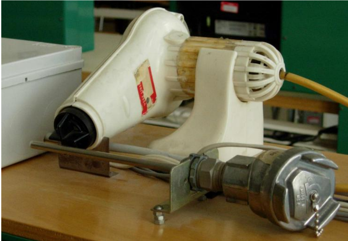
3-2 Laboratorní model fénu s teplotním čidlem
