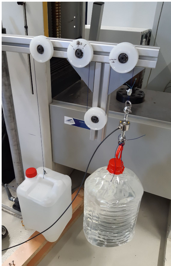
Obr. 25: Fotografie nastavení porovnávacího testu odporů kladek
