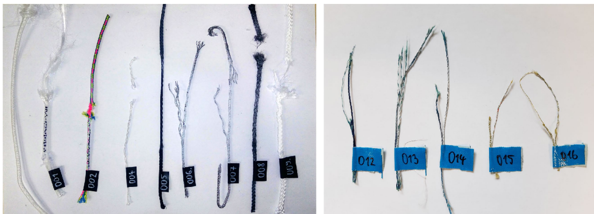
Obr. 27: Fotografie vzorků po porovnávacím testu na trhačce
