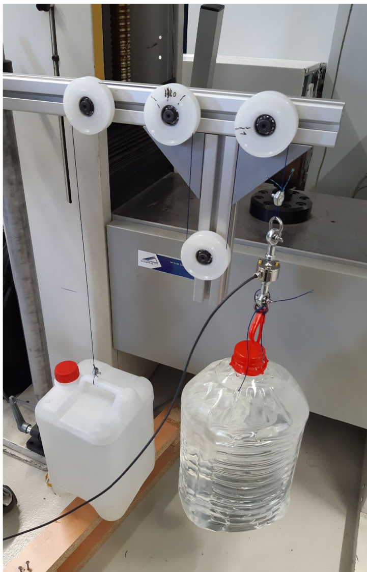
Obr. 25: Fotografie nastavení porovnávacího testu odporů kladek
