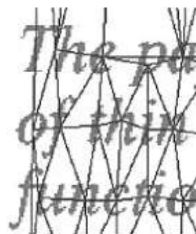
Obr. 2.4: Delaunay triangulácia na centroidoch spojených komponentov. [53]
