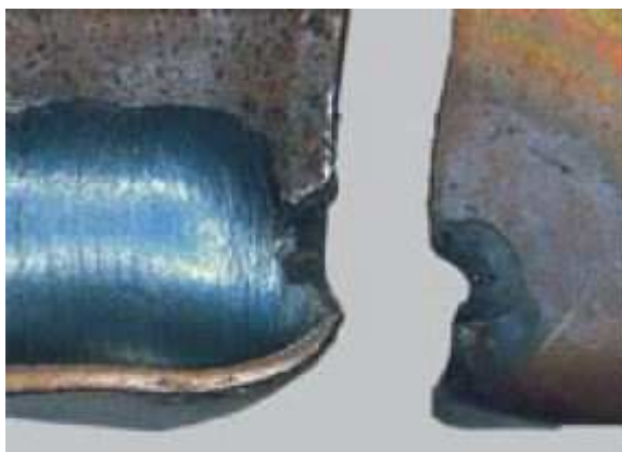
Obr. 20 Oxidační rýha na vedlejším břitu [10]
