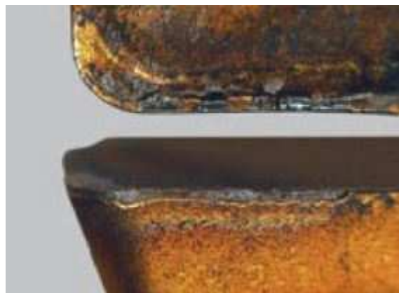
Obr. 24 Křehké porušení řezné hrany [10]
