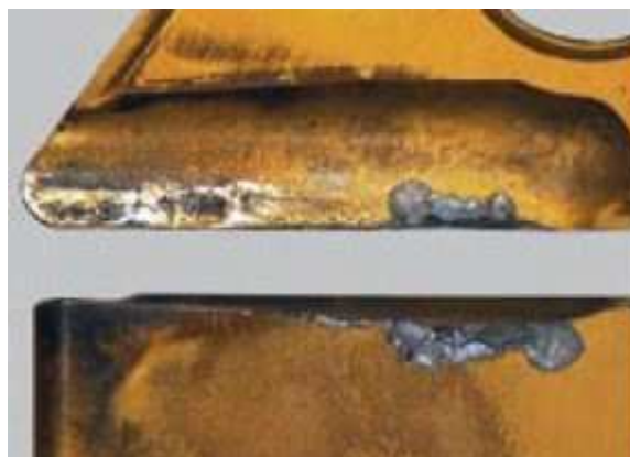
Obr. 25 Porušení řezné hrany (mimo záběr) [10]
