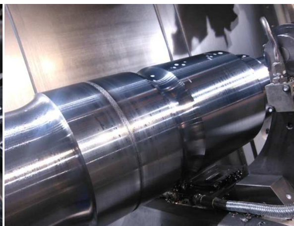
Obr. 38 Obráběná sedla pro kolo a brzdový kotouč
