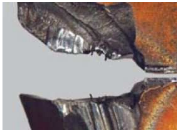
Obr. 27 Destrukce špičky nástroje [10]
