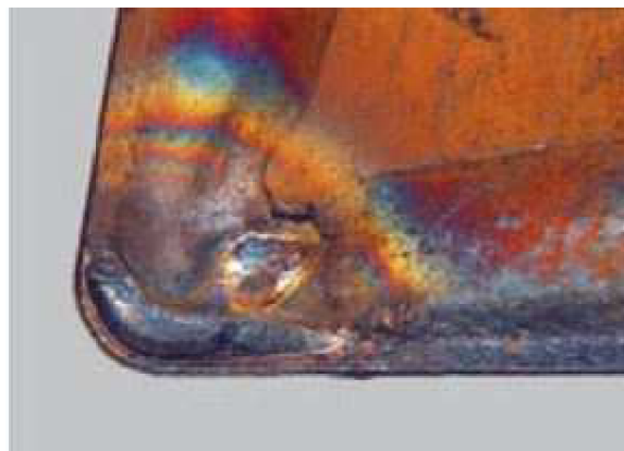
Obr. 19 Výmol na čele [10]
