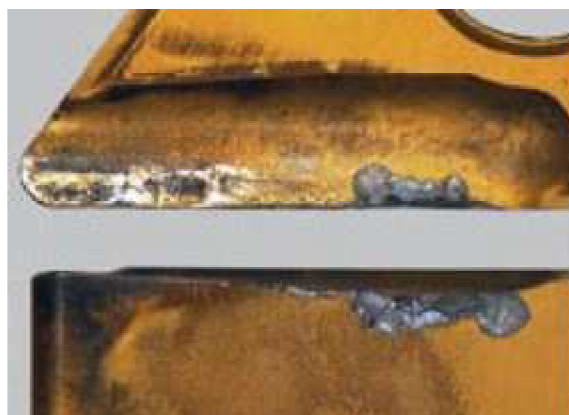
Obr. 25 Porušení řezné hrany (mimo záběr) [10]
