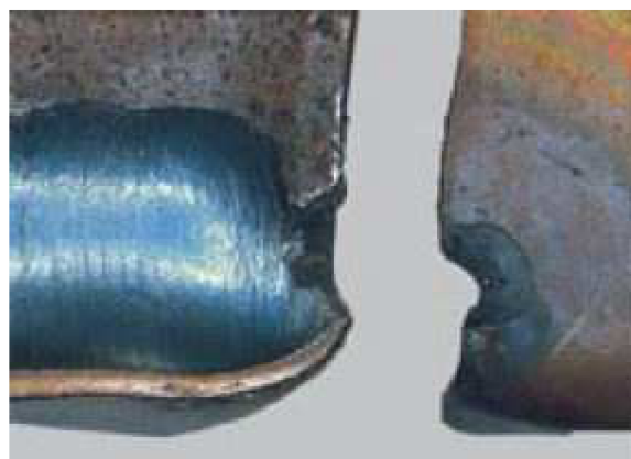
Obr. 20 Oxidační rýha na vedlejším břitu [10]
