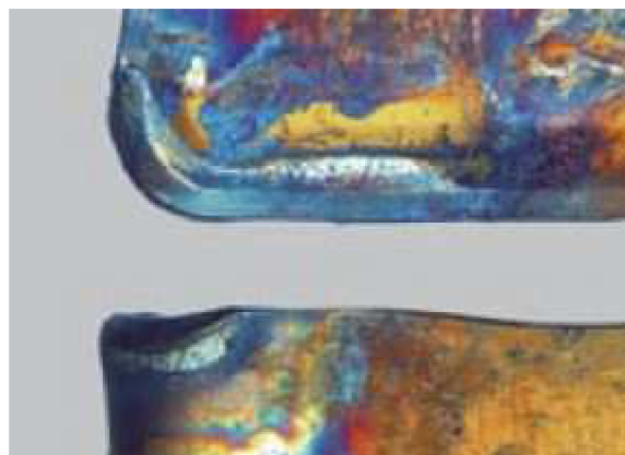
Obr. 22 Plastická deformace špičky [10]
