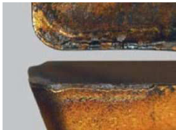
Obr. 24 Křehké porušení řezné hrany [10]
