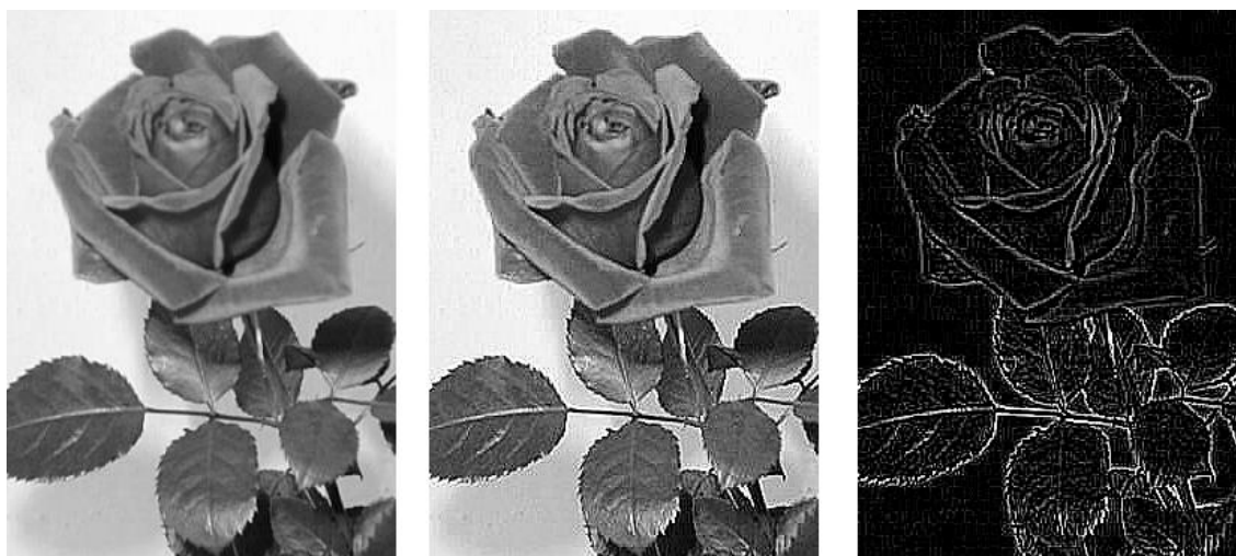
Obrázek 2.9: Vstupní obrázek, obrázek po zvýraznění hran a po detekci hran aplikováním různých operátorů
