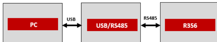
1.24 Blokové zapojení pro konfiguraci a programování R356 [11]
