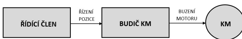
1.13 Princip řízení v otevřené smyčce
