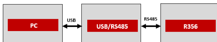
1.24 Blokové zapojení pro konfiguraci a programování R356 [11]
