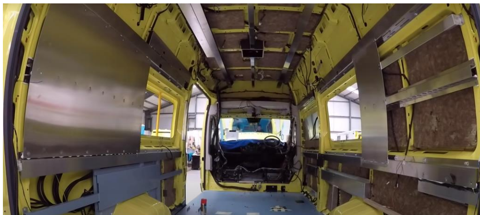
Obr. 2-39 Výstavba ambulantního vozu společností EMAS HNS s kompletní dodávkovou karosérií [27]
