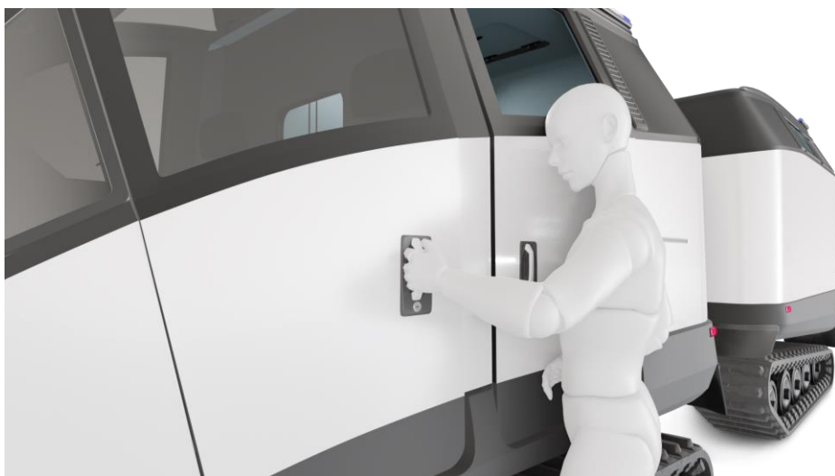
Obr. 6-38 Ergonomické řešení výšky kliky dveří
