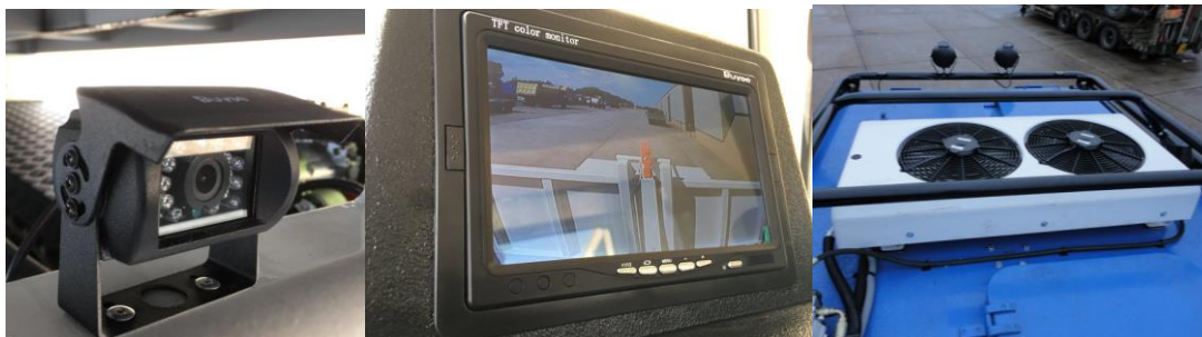
Obr. 2-38 Kamerový systém (vlevo), displej (uprostřed), klimatizace (vpravo) [6]
