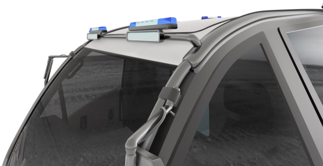
Obr. 6-27 Detailní pohled na napojení nárazníku se střešní konstrukci
