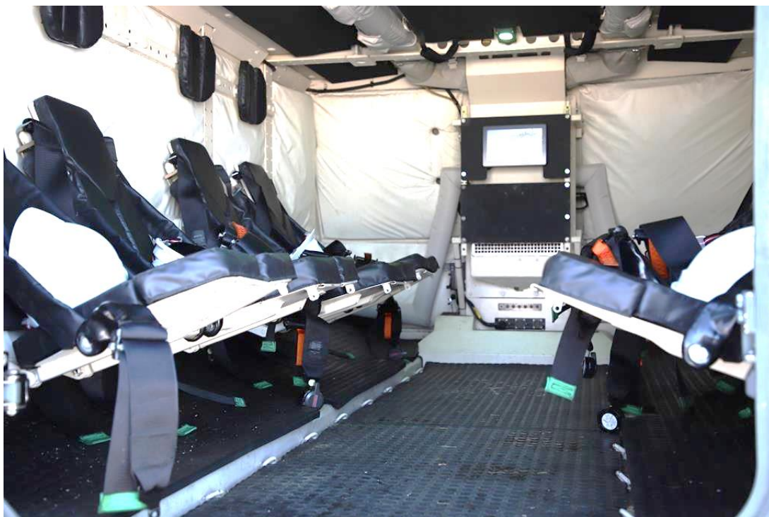
Obr. 2-5 Interiér zadního modulu vozidla BV206 [8]
