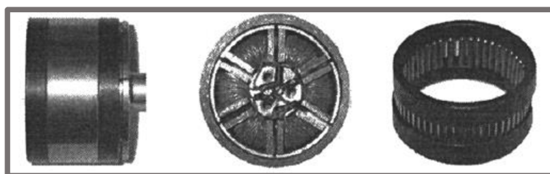
Obr. 15 Umístění cívek a magnetů v pístu tlumiče [12]
