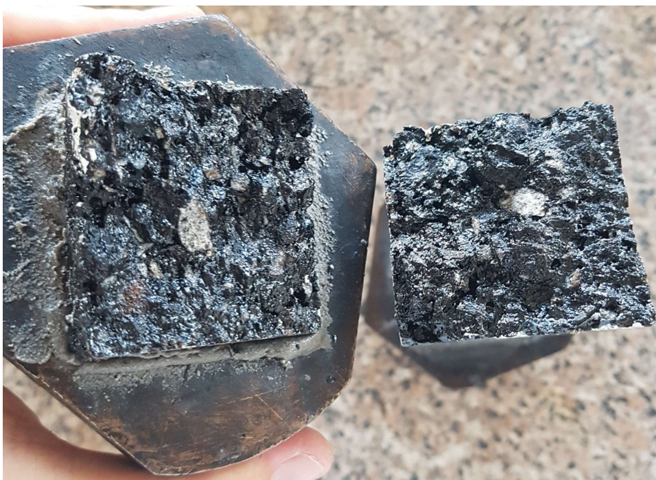
Obrázek 23: Porušený vzorek po zkoušce TSRST
