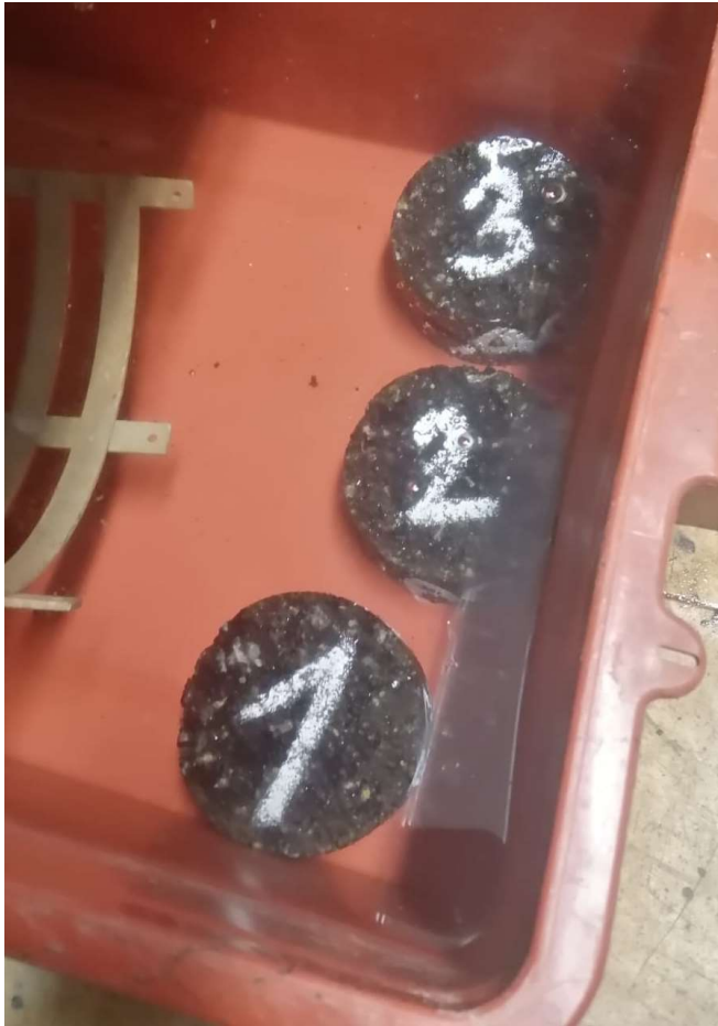
Obrázek 19: Ponoření marshallových těles pro určení objemové hmotnosti
