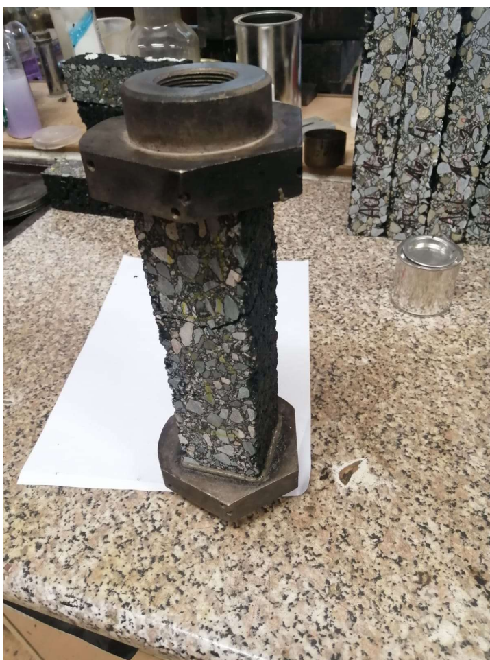
Obrázek 29: Vlepené těleso do formy pro zkoušku TSRST
