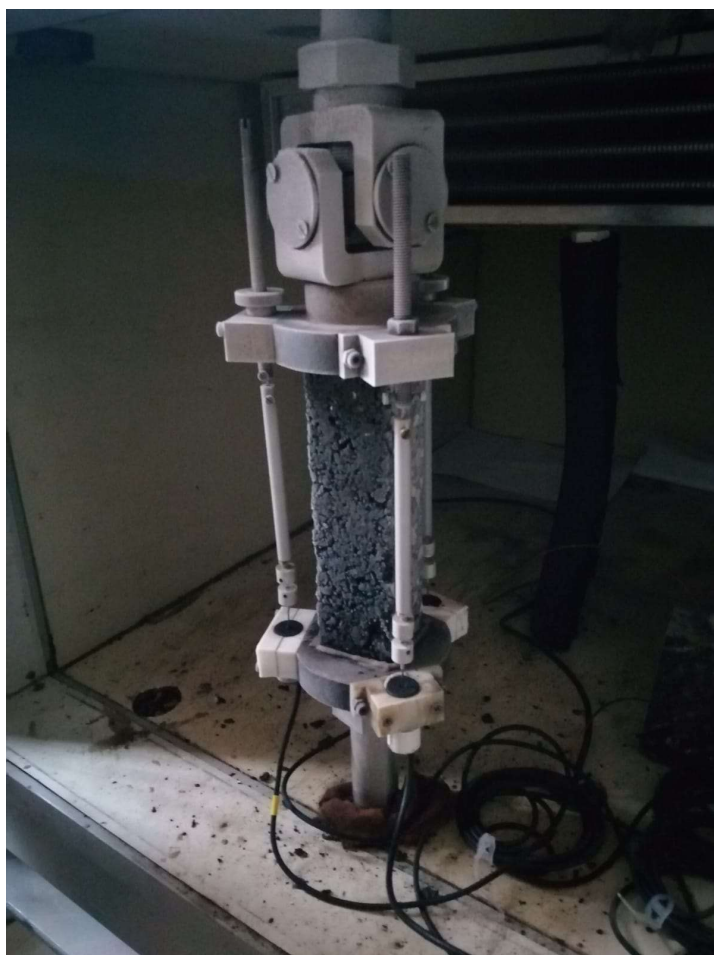
Obrázek 22: Příklad přístroje pro zkoušku TSRST s upnutým vzorkem
