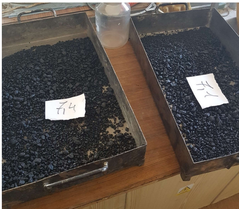
Obrázek 20: Dvě směsi pro určení maximální objemové hmotnosti
