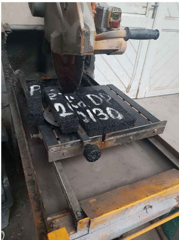
Obrázek 27: Kotoučová pila s pojízdňým stolem
