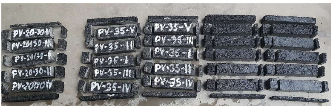
Obrázek 28: Nařezaná tělesa pro zkoušku TSRST
