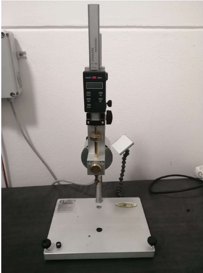
Obrázek 5: Příklad pro zkoušku penetrace jehlou
