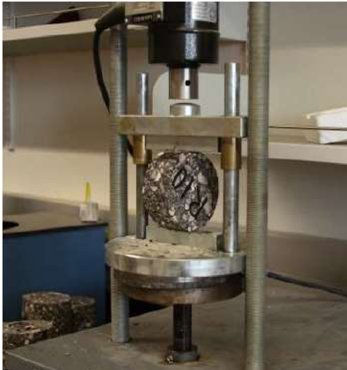
Obrázek 4: Příklad pro určení pevnosti v příčném tahu [8]
