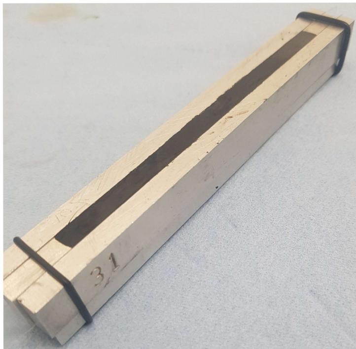
Obrázek 13: Zaformovaný vzorek pro zkoušku průhybovým trámečkovým reometrem
