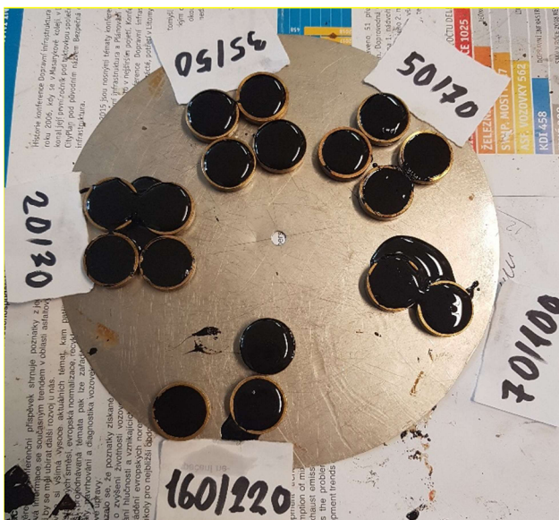
Obrázek 8: Vzorky všech použitých pojiv pro zkoušku bodu měknutí
