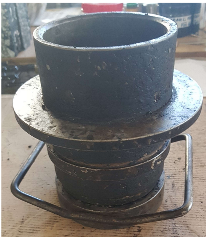
Obrázek 18: Forma pro výrobu marshallových těles
