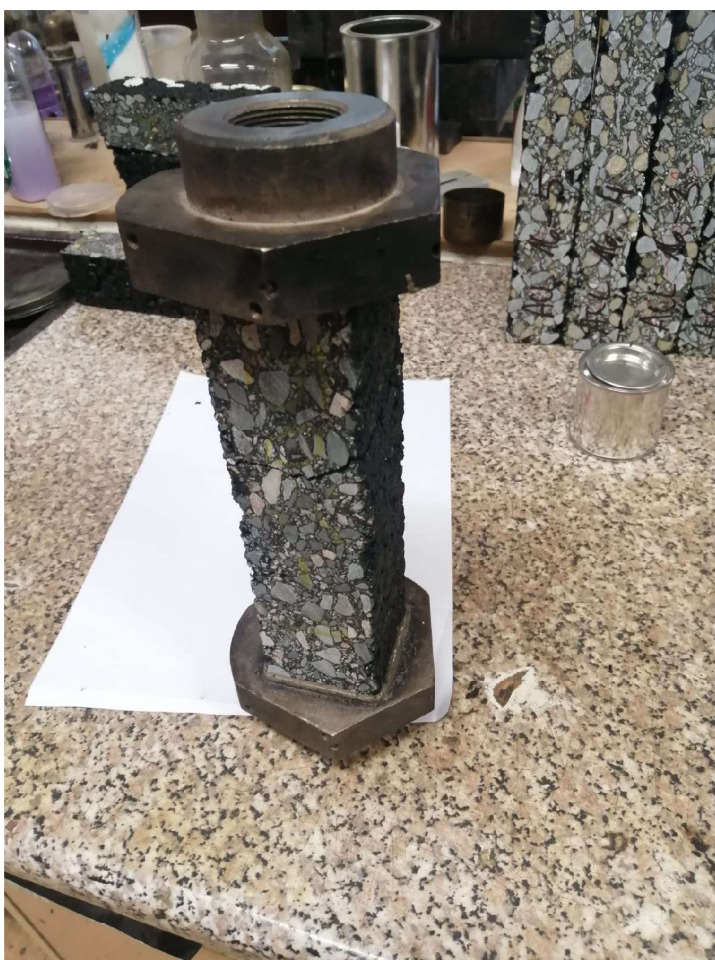
Obrázek 29: Vlepené těleso do formy pro zkoušku TSRST
