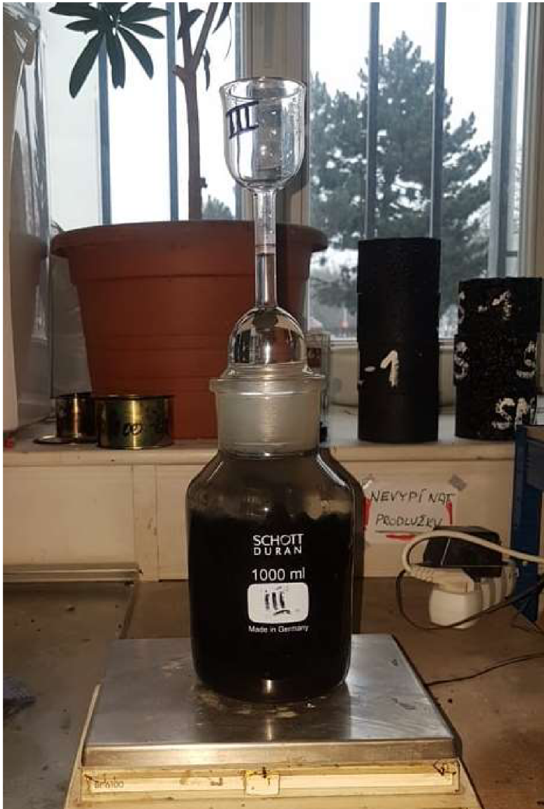
Obrázek 21: Pycnometr s testovanou směsí
