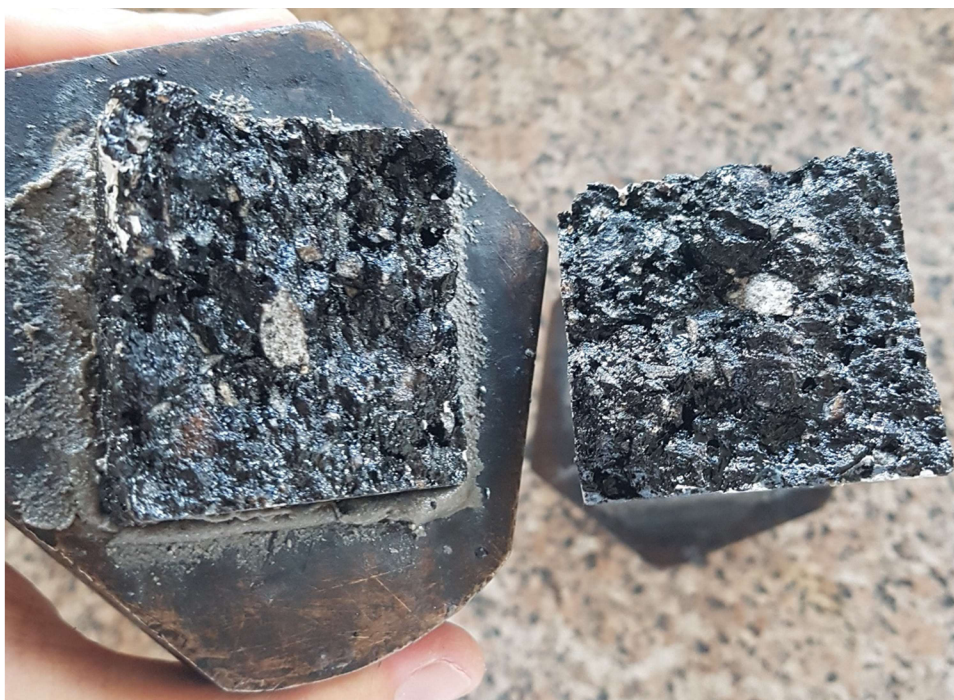
Obrázek 23: Porušený vzorek po zkoušce TSRST
