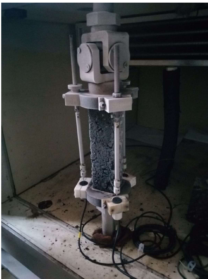
Obrázek 22: Přístroj pro zkoušku TSRST s upnutým vzorkem
