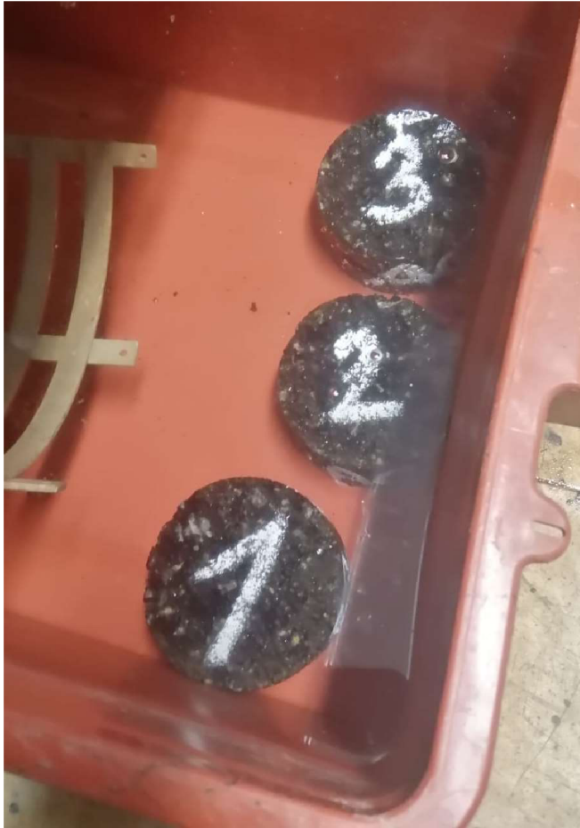
Obrázek 19: Ponoření marshallových těles pro určení objemové hmotnosti
