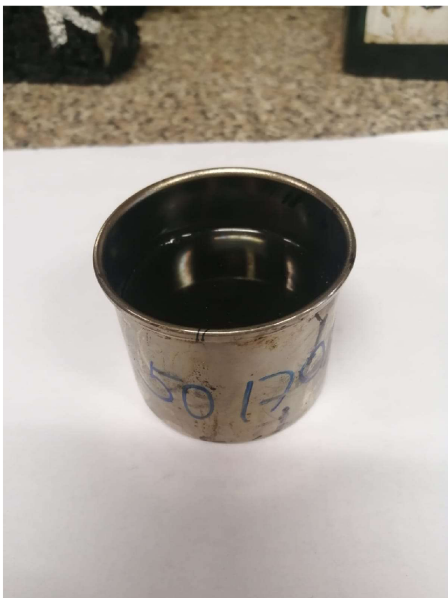
Obrázek 6: Vzorek pro zkoušku penetrace jehlou
