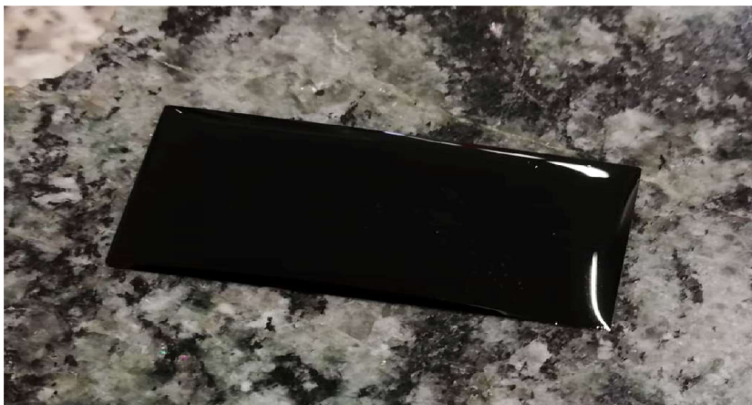
Obrázek 10: Vzorek pro provedení zkoušky dle bodu lámavosti dle Fraasse
