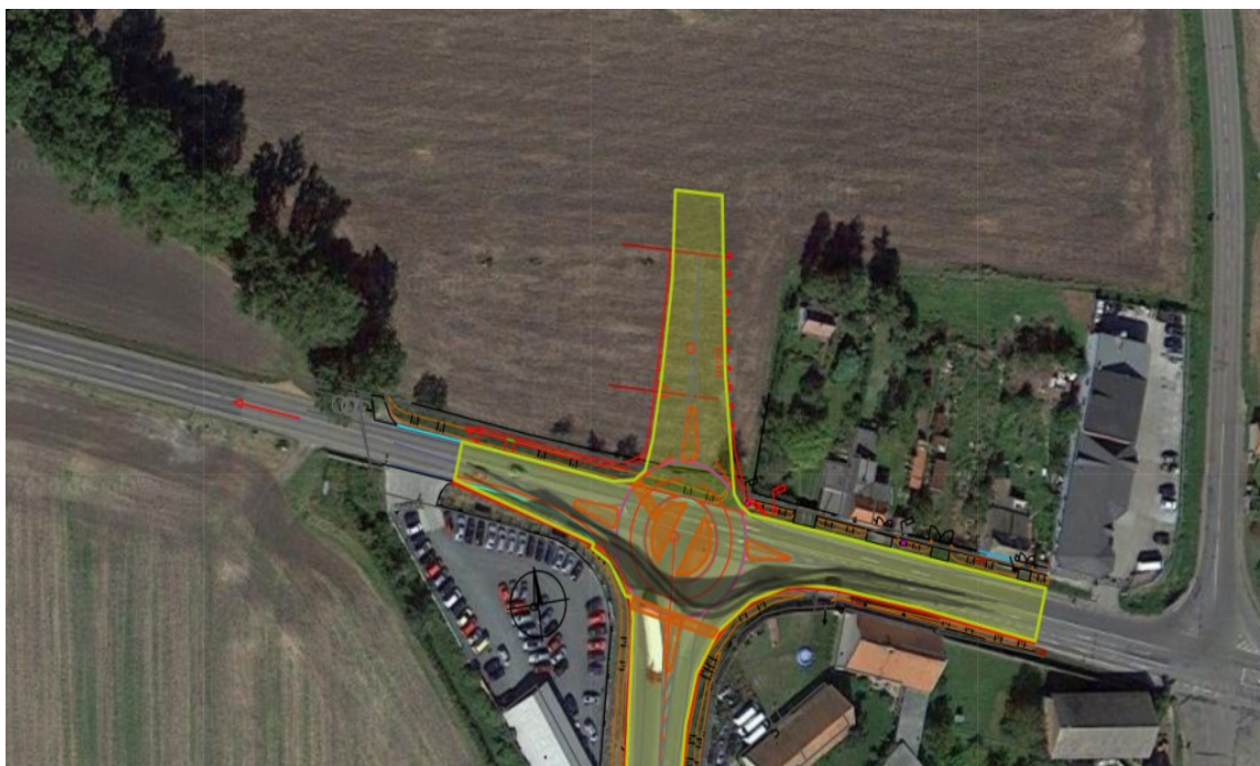
Obr. 3.3 Vlečné křivky průjezdu soupravy kruhová křižovatka Starý Vestec.
