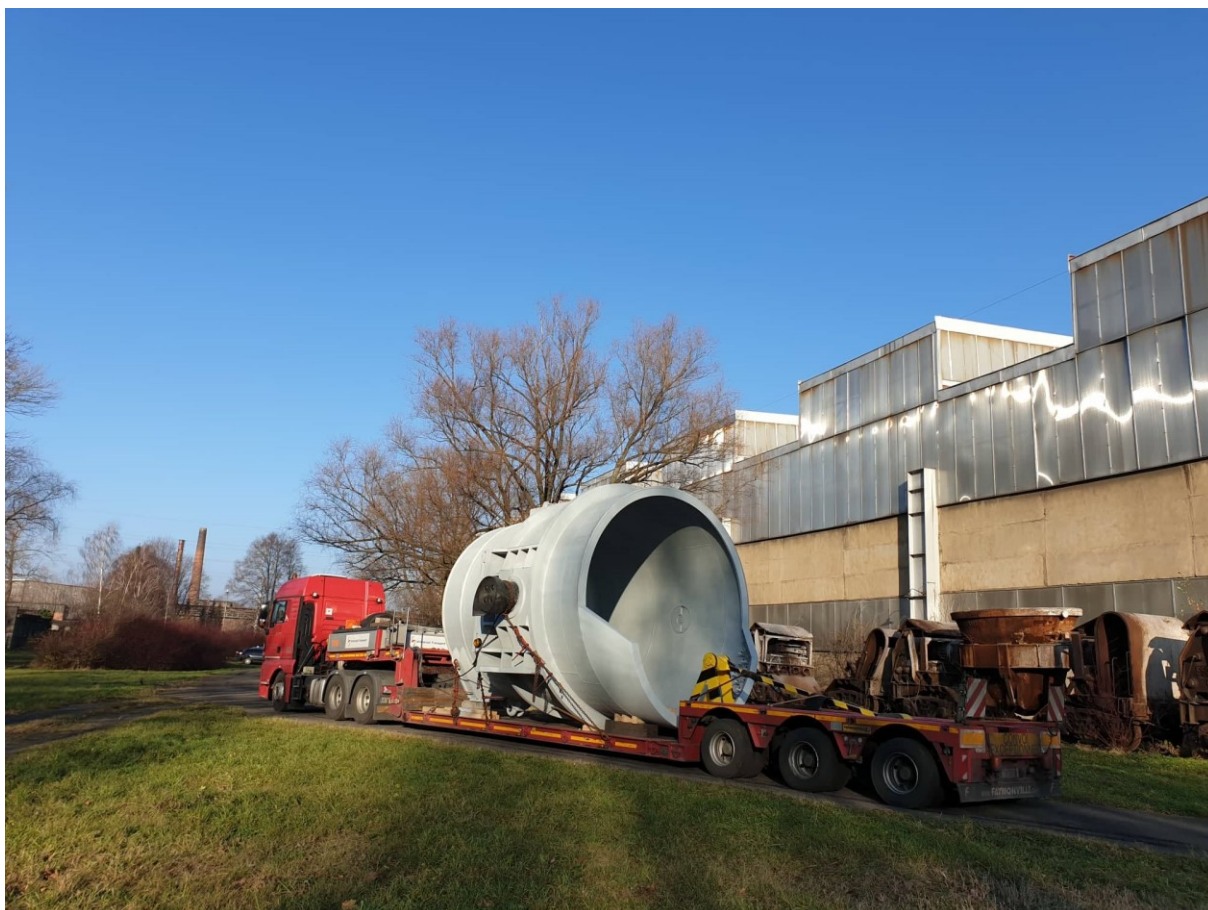
Obr. 2.13 Naložená souprava s třínápravovým hlubinným návěsem Zdroj: [18].
