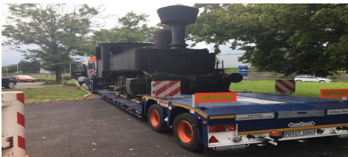
Obr. 2.11 Naložená souprava s dvojnápravovým hlubinným návěsem
