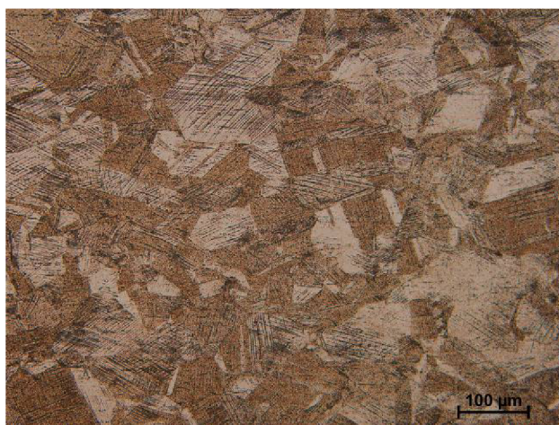
Obr. 17: Mikrostruktura oceli 17 240, základní materiál
