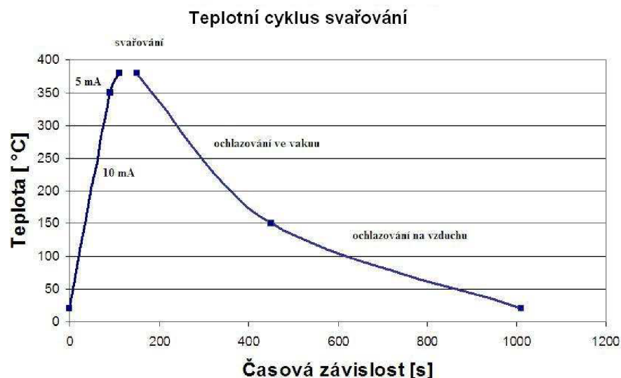
Graf 3: Teplotní cyklu elektronového svařování oceli 17 153
