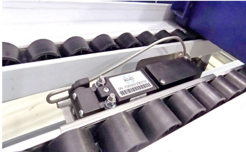
Obr. 3.6 SSW senzor umístěný na válečkovém skluzu v regálu
