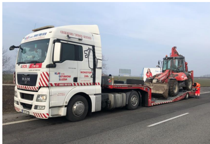
Obrázok 65 - ťahač MAN TGS 18.480 a podvalník FGM 19 TT Line (23)
