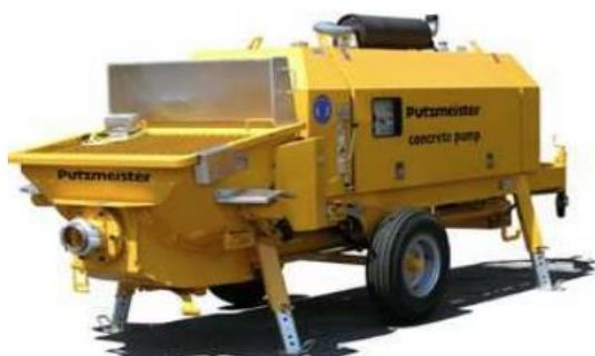
Obrázok 69 - Stabilné čerpadlo Putzmeister 1409 (27)
