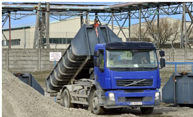
Obrázok 76 - VOLVO FE 320 s jednoramenným nosičom kontajneru (12)
