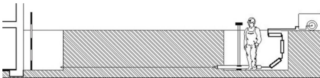
Obrázek 3 –Metoda propichování. Zdroj: https://www.czstt.cz/sites/default/files/1.2012-2.brozura.pdf
