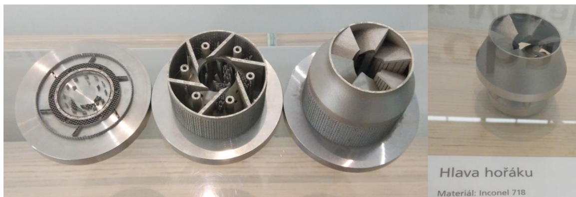
Obr. 14 Vytisknutý díl z 3D tiskárny včetně podpor a finální výrobek.
