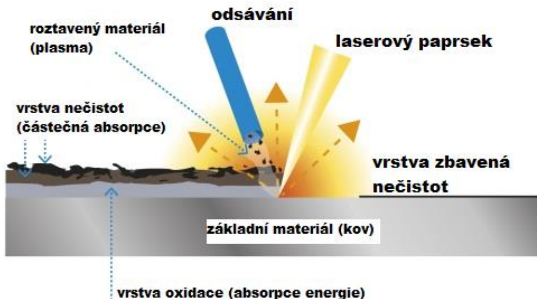
Obr. 12 Princip čištění laserem. [21]
