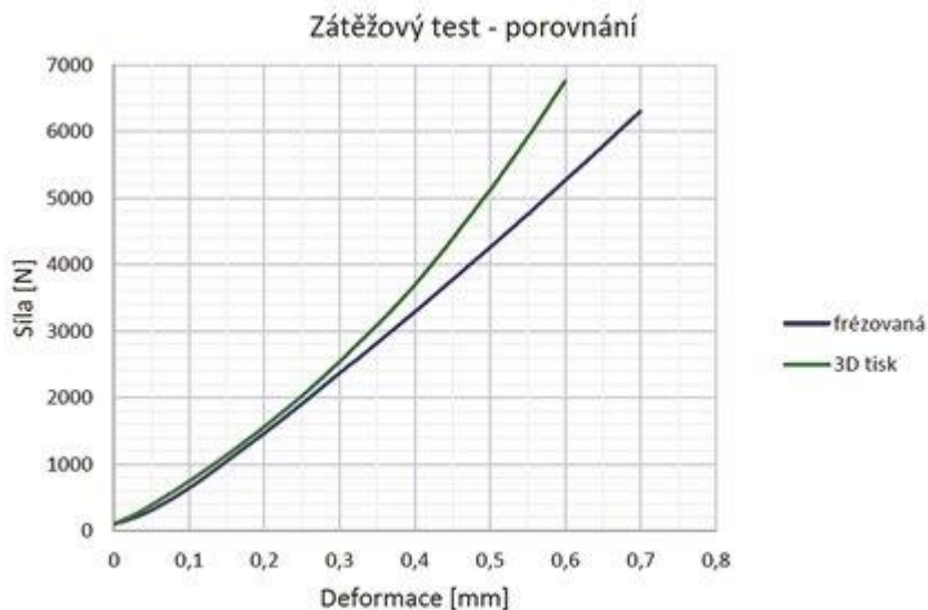
Obr. 16 Diagram zátěžového testu frézované a tisknuté součásti. [10]
