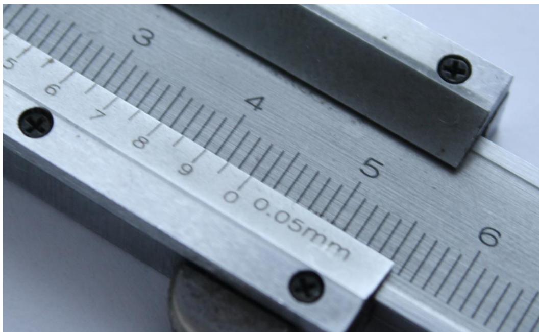
Obr. 11 Dílky posuvného měřidla značené laserem.
