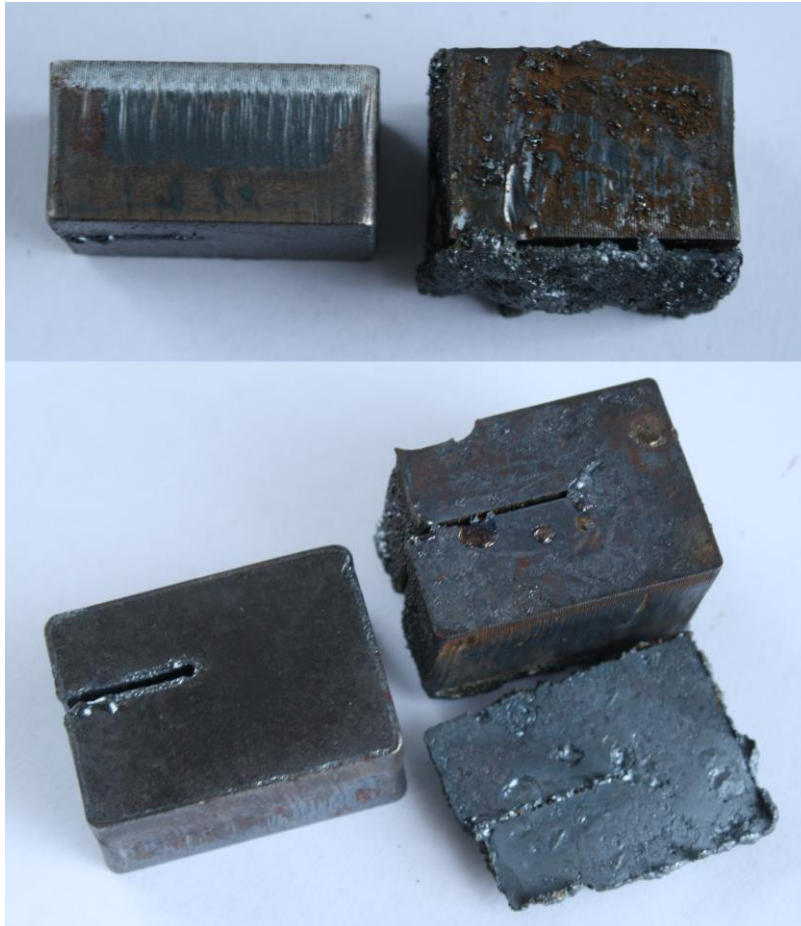
Obr. 6 Technologická vada vpravo – nastaveny špatné parametry řezání.
