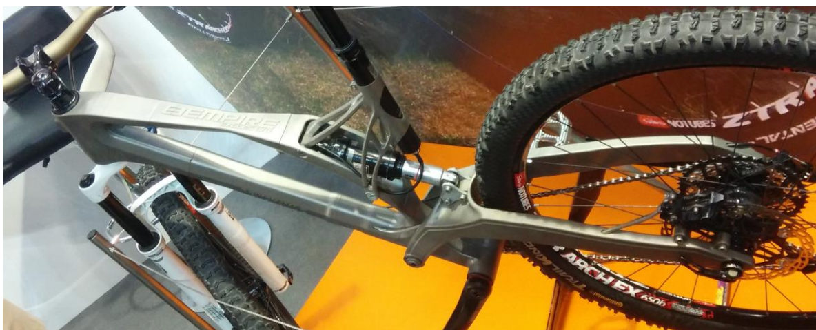
Obr. 17 Titanový rám kola vyrobený metodou 3D tisku.
