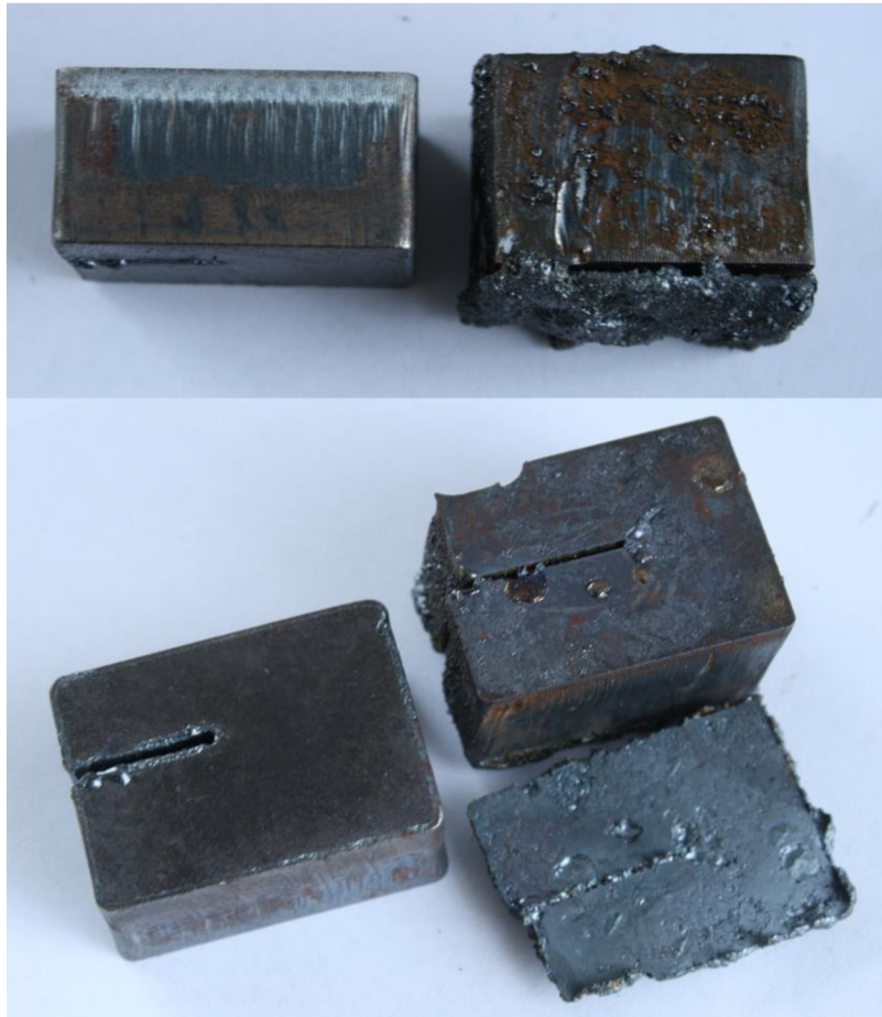
Obr. 6 Technologická vada vpravo – nastaveny špatné parametry řezání.
