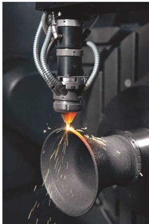
Obr. 18 Laserové navařování příruby pomocí prášku. [15]
