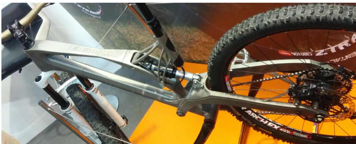
Obr. 17 Titanový rám kola vyrobený metodou 3D tisku.
