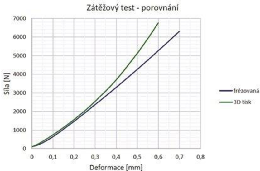
Obr. 16 Diagram zátěžového testu frézované a tisknuté součásti. [10]
