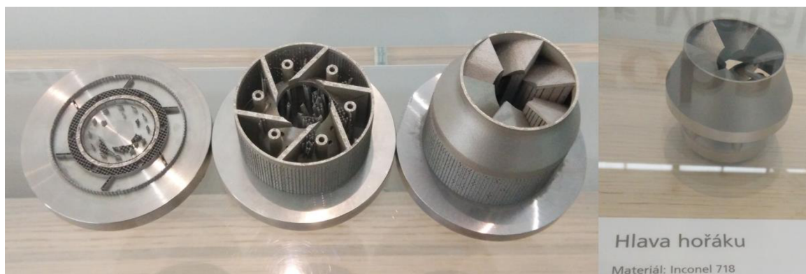
Obr. 14 Vytisknutý díl z 3D tiskárny včetně podpor a finální výrobek.
