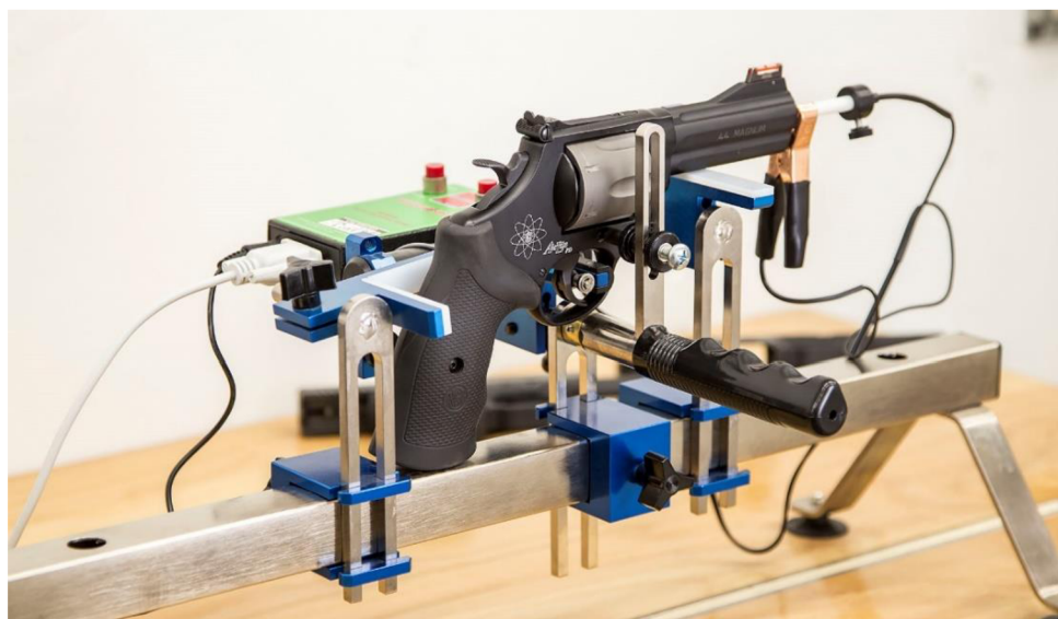
Obrázek 7: Upínač zbraně – TriggerScan™ společnosti Dvorak instruments [16]
