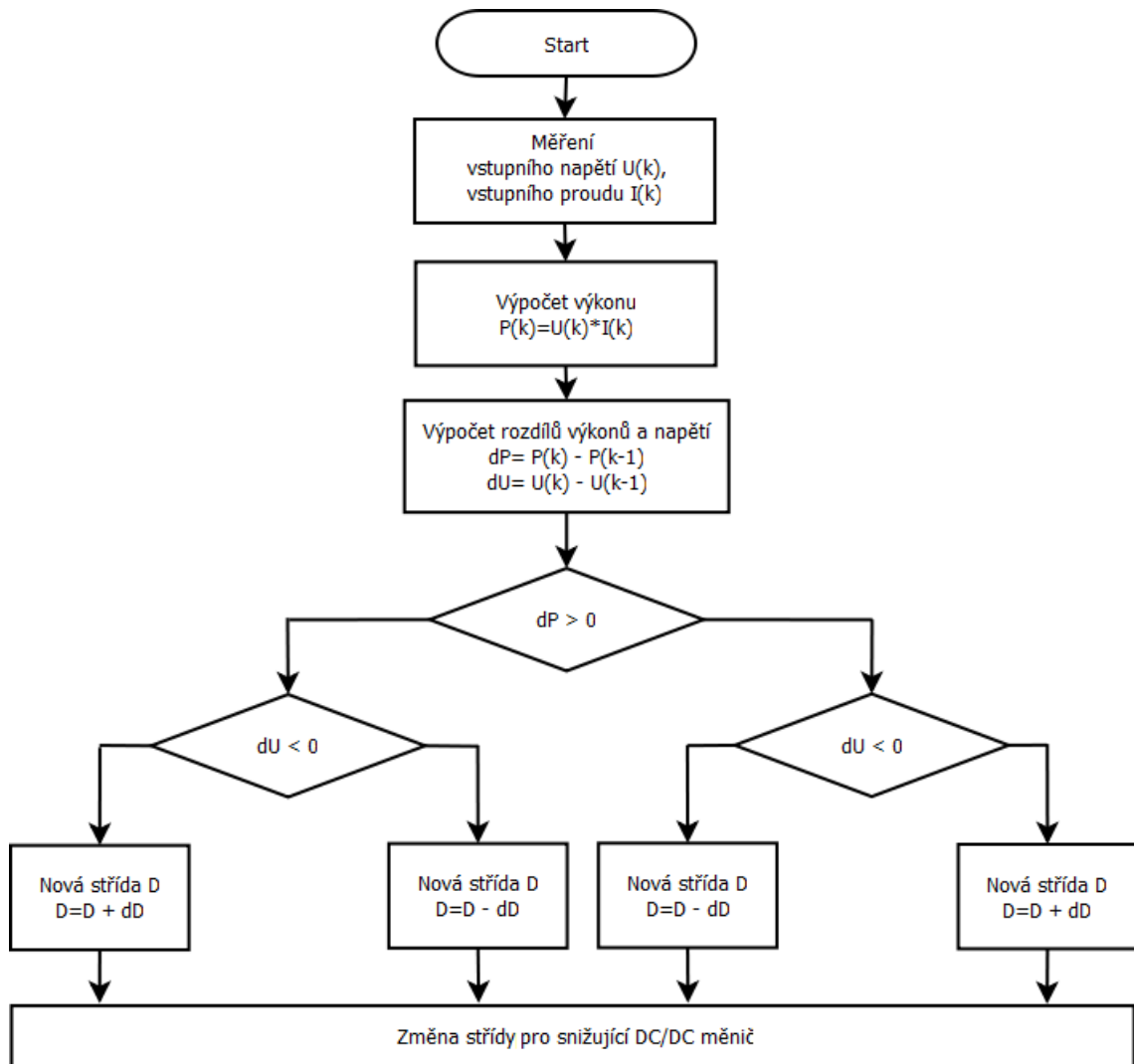
Obr. 5.7.1: Vývojový diagram popisující algoritmus MPPT P&O
