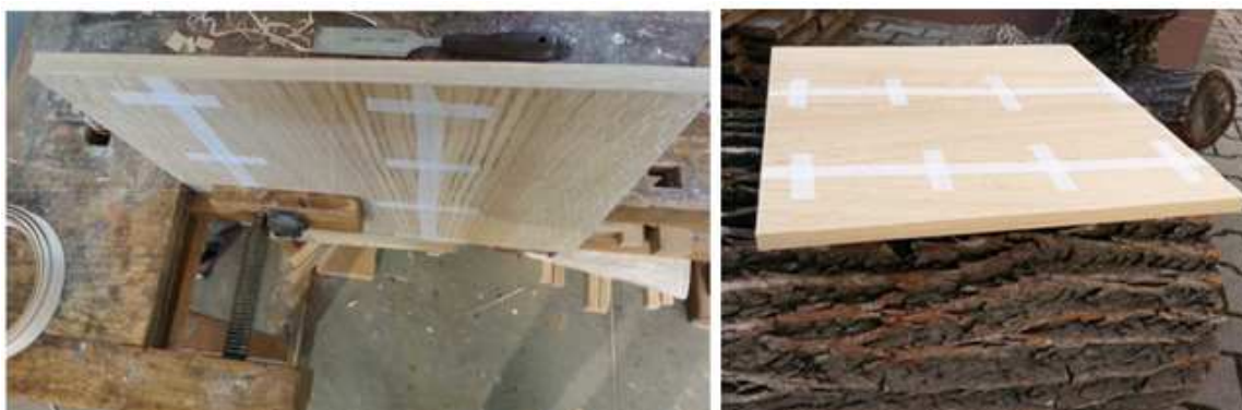
Obr. 15: Ruční olepění hran (vpravo) a zadýhovaný dílec DTD-DB s olepěnými bočními plochami
