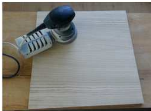
Obr. 16: Broušení zadýhovaného dílce ruční bruskou
