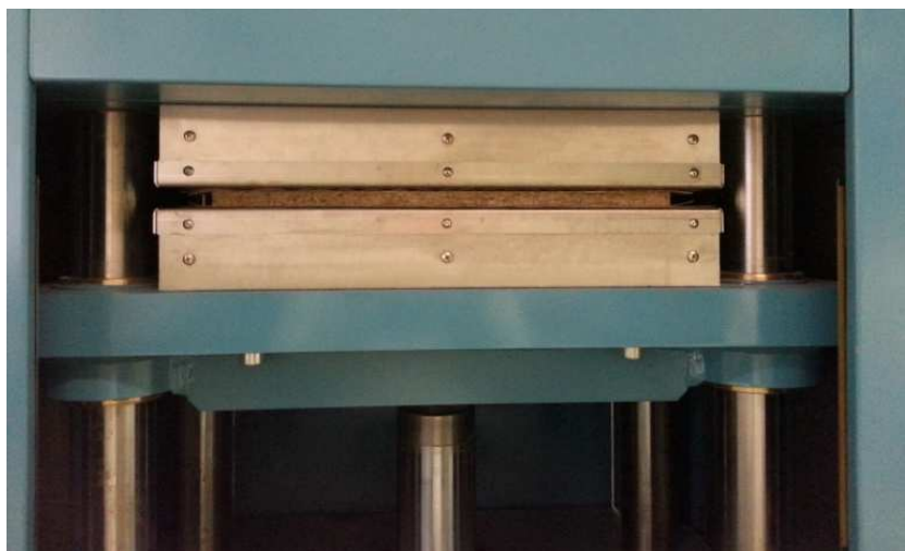
Obr. 14: Lisování zkušební dílce (DTD + UF lepidlo + DB dýha) v hydraulickém lisu
