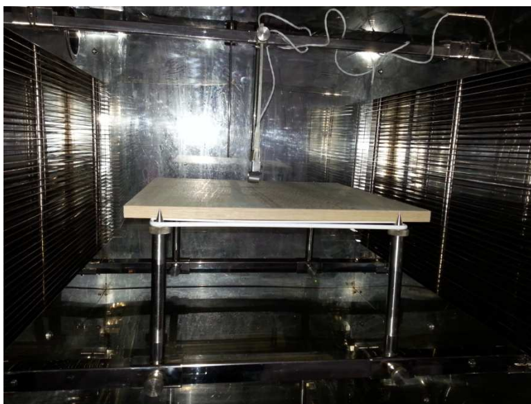
Obr. 23: Zadržovaný dílec DTD-DB bez PÚ umístěný ve zkušební komoře
