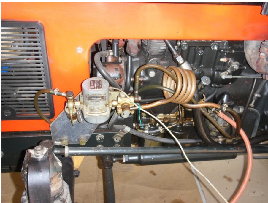
Obr. 7.4 Měřič spotřeby typ ADAST 8500.06. Foto: Martin Holý
