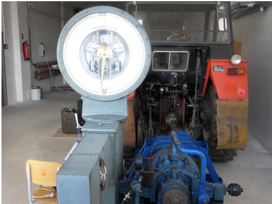
Obr. 7.3 Dynamometr typ VD 110/6. Foto: Martin Holý
